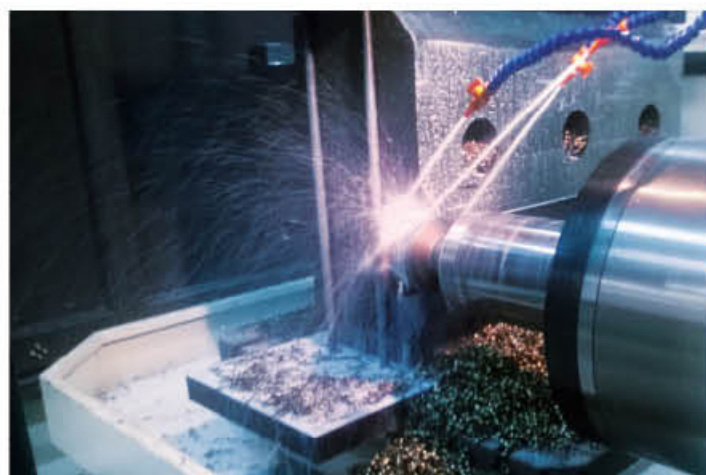
深海页岩油泵体加工
